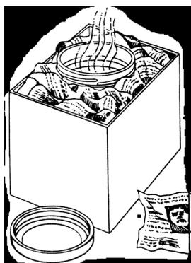
1. Stelle ein Glas in die Schachtel und umhülle den Zwischenraum mit lose zusammengeknülltem Zeitungspapier.
