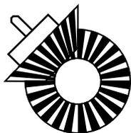
Diese Abbildung stellt ein Kegelaradgetriebe dar, bei dem die Drehbewegung eines Zahnrades auf eine rechtwinklig dazu geneigte Achse übertragen wird.
