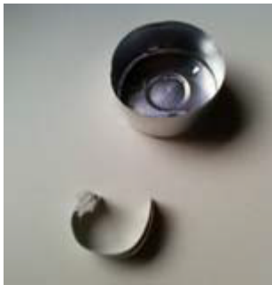
Teelichtbecher mit dem in einen Metallstreifen eingewickelten Docht
